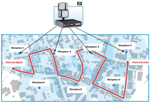
Schéma fonctionnel de l'application de transmission de Video piétonne ou mobile via un relayage sur les nodes LUMIERES équipés de Récepteurs produisant un Stream Vidéo Ethernet .
