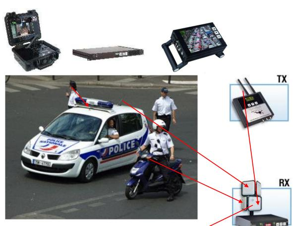
Le piéton ou le mobile moto est en direct sur le relais RX ou relayé par la Voiture vers l'antenne Diversité implantée sur un site relais ou nodal du réseau maillé (ex. LUMIERES)
